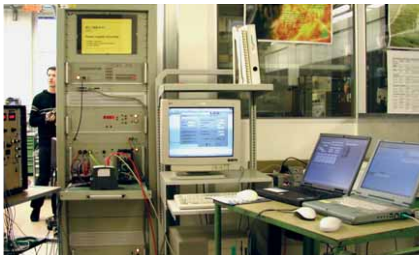
Medición del comportamiento de los aparatos en caso de caídas y oscilaciones de tensión o de interrupciones de corta duración del suministro de energía auxiliar.
